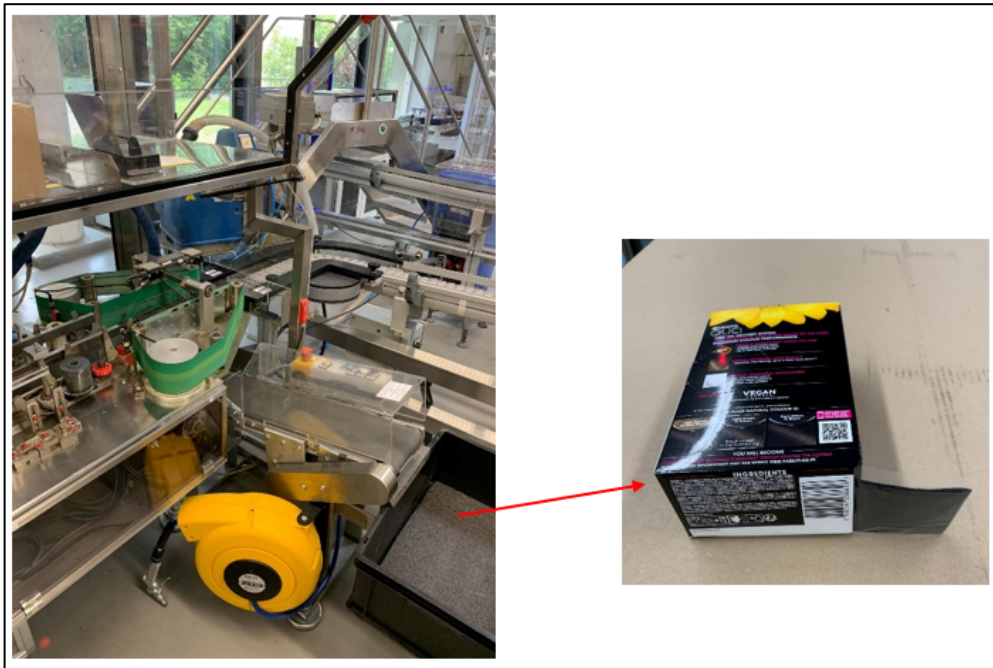
Figure 25 : Photo de la fin de l'étuyeuse et d'un kit éjecté pour non-conformité
