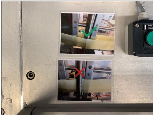
Figure 19 : Photo des visuels placés sur la machine représentant le bon placement du support d'étiquettes derrière la tête d'étiquetage
