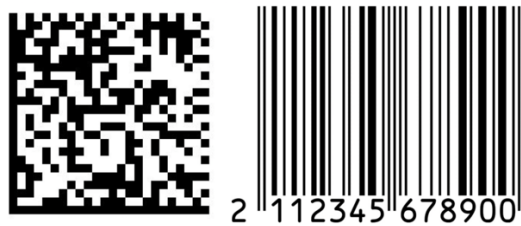
Figure 8 : Illustration des deux types de code-barres (code-barre data matrix à gauche, code-barre actuel EAN à droite)
