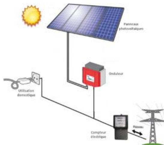
Figure 6 : Configuration d'une installation photovoltaïque
