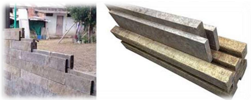
Figure 16 : briques standards obtenu par extrusion
