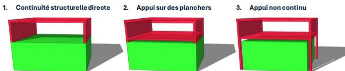
Figure 1 : Innovlris. (2011). 3 schémas représentant les différents points d'appuis possibles pour une surélévation.
