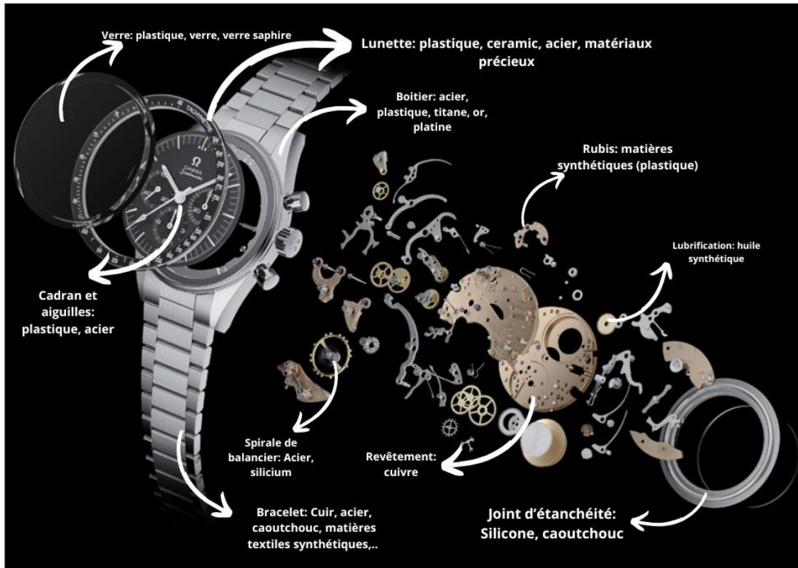
Figure 3: Vue éclatée d'une montre mécanique et ses différents matériaux Source: MyWatch. (2021, 16 mars). Omega Speedmaster à Calibre 321 - MyWatch FR. MyWatch FR. https://www.my-watchesite.fr/blog/omega-speedmaster-moonwatch-calibre321-acier-n2468/
